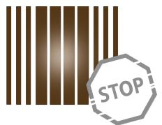
Fig. 3 - RÉSULTAT INCORRECT Une décoloration apparaît au centre de la feuille-test. Le changement de couleur n'est pas uniforme.
