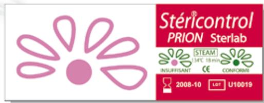
Le **Stérickontrol Prion** est un **indicateur d'émulsion séquentiel** de contrôle des paramètres de stérilisation à la vapeur d'eau, de 134°C à 138°C.
